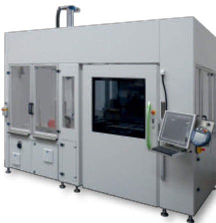
RobolInspect kombiniert mit Verpackungsmodul (Verpacken, Deckeln, Etikettieren, Ab stapeln)
