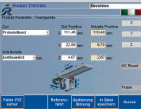
Einrichtbetrieb: Roboter Teach-in
